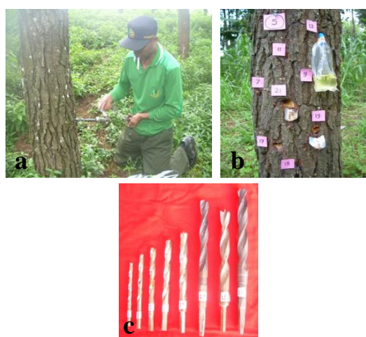
Gambar 1. Pelaksanaan penyadapan (a) Bor engkol, (b) Lubang bor secara berseri dan (c) Ukuran mata bor
